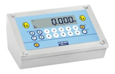
Indicatore di peso per zone classificate a rischio di esplosione. Grado di protezione: ATEX II 2(2)G Ex ib [ib Gb] IIC T4 Gb per gas ATEX II 2(2)D Ex tb [ib Db] IIIC T197°C IP65 Db per polveri.
