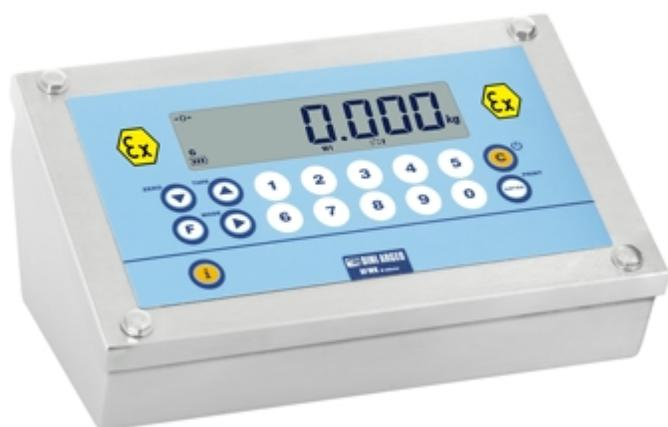
Indicatore di peso per zone classificate a rischio di esplosione. Grado di protezione ATEX II 2(2)G Ex ib [ib Gb] IIC T4 Gb per gas, ATEX II 2(2)D Ex tb [ib Db] IIIC T197°C IP65 Db per polveri. Indicato per realizzare sistemi di pesatura, dosaggio e automazione. Certificato di esame CE del tipo secondo Allegato III (direttiva ATEX). Omologabile CE-M (OIML R-76 / EN 45501).
