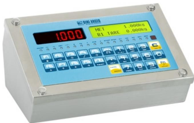
Indicatore di peso per zone classificate a rischio di esplosione. Grado di protezione ATEX II 3G Ex nR IIC T6 Gc X per gas ATEX II 3D Ex tc IIIC T85°C Dc IP68 X per polveri. La vasta gamma di programmi disponibili garantisce la massima versatilità. Stampe completamente configurabili e alibi memory integrata di serie. Omologabile CE-M (OIML R-76 / EN 45501).
