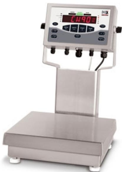
CW90X è una bilancia concepita per l'utilizzo a contatto con alimenti e rispetta i requisiti d'igiene riconosciuti da NSF. La struttura completamente in acciaio INOX e il grado di protezione IP69K permettono la completa sanificazione della bilancia con l'utilizzo di getti d'acqua ad alta temperatura e pressione. L'indicatore di peso offre caratteristiche uniche nel suo genere, come la robusta tastiera piezoelettrica, studiata per durare nel tempo, anche negli ambienti più gravosi.
